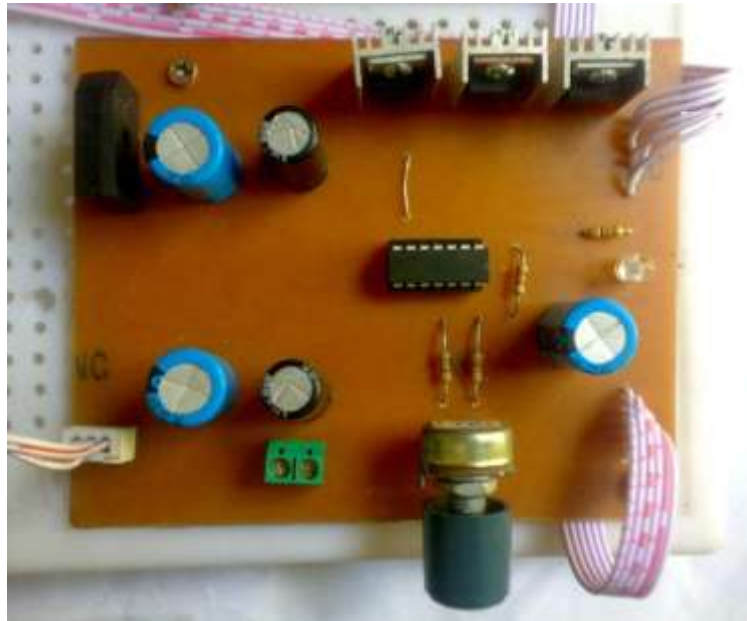
Hình 3.7. Mạch nguồn và điện áp điều khiển đã thi công xong.
