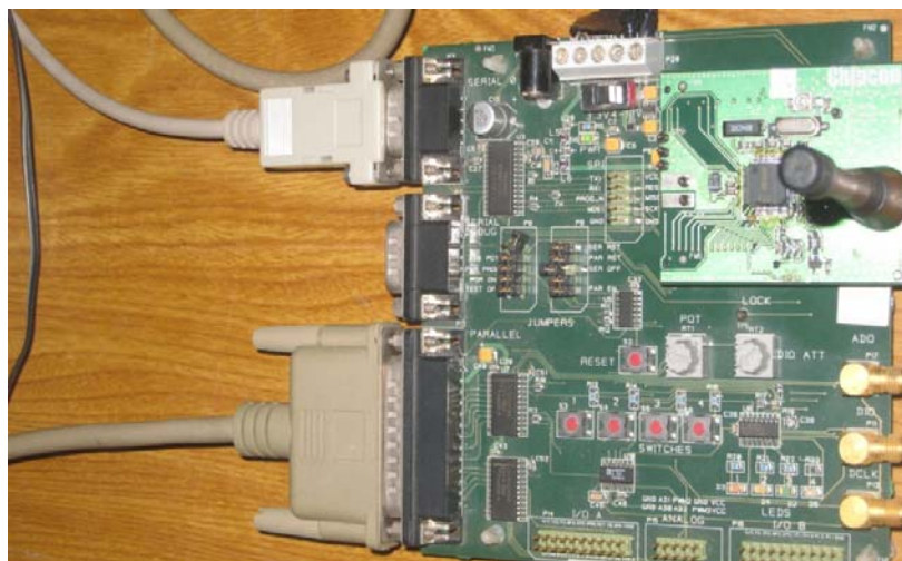
Hình 4.1: Gắn nút mạng vào bản mạch đã nối với hệ thống PC.
