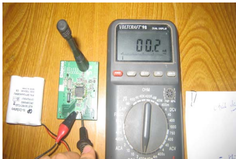
Hình 4.4: Đo dòng điện mà nút mạng tiêu thụ trong chế độ nghỉ.
