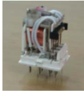
Hình 4.24. Hình ảnh bên trong của role trung gian
