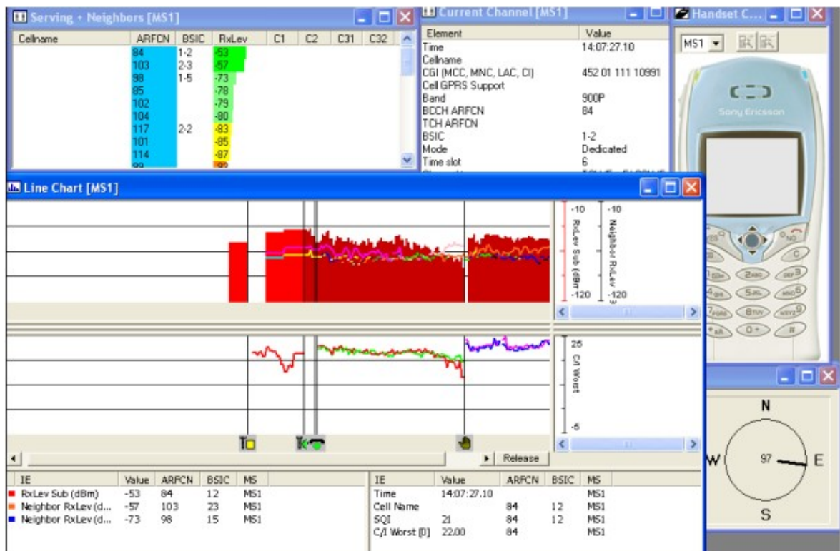
Hình 6-52 Đo kiểm tra Handover từ trạm Trương Định sang trạm Đại La
