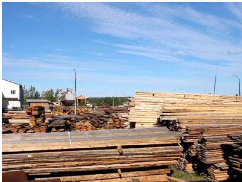
Gỗ được xẻ mỏng, phân loại, chuẩn bị chuyển về nhà máy chính để nghiền nhỏ và đưa vào sản xuất ván HDF.
