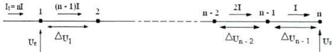
Hình 1.7. Điện áp rơi trên đường trục.
