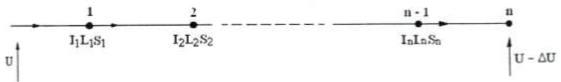
Hình 1.8. Độ sụt áp trên đường dây có tiết diện khác nhau.
