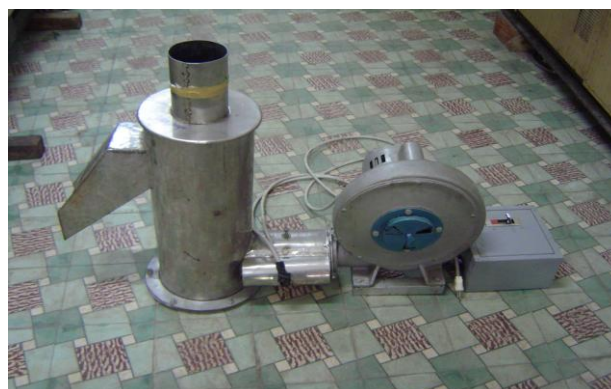
Hình 2.6: Hệ thống máy sấy tầng sôi trong nghiên cứu
