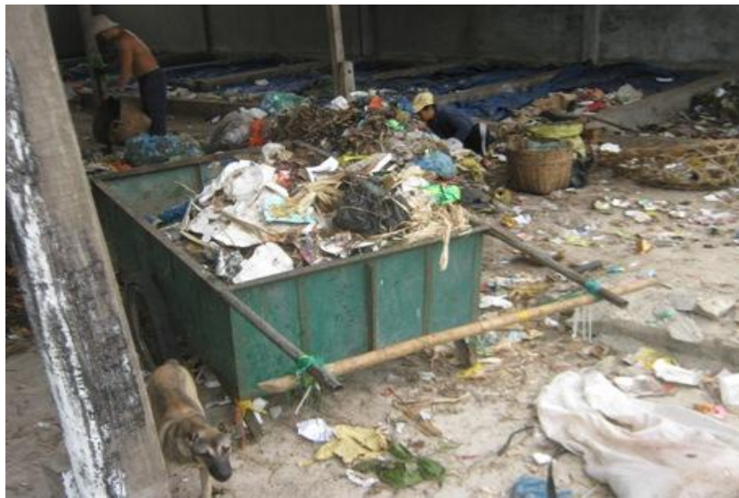
Hình 4.8: Sử dụng xe đẩy để di chuyển rác từ bãi đổ đến băng tải
