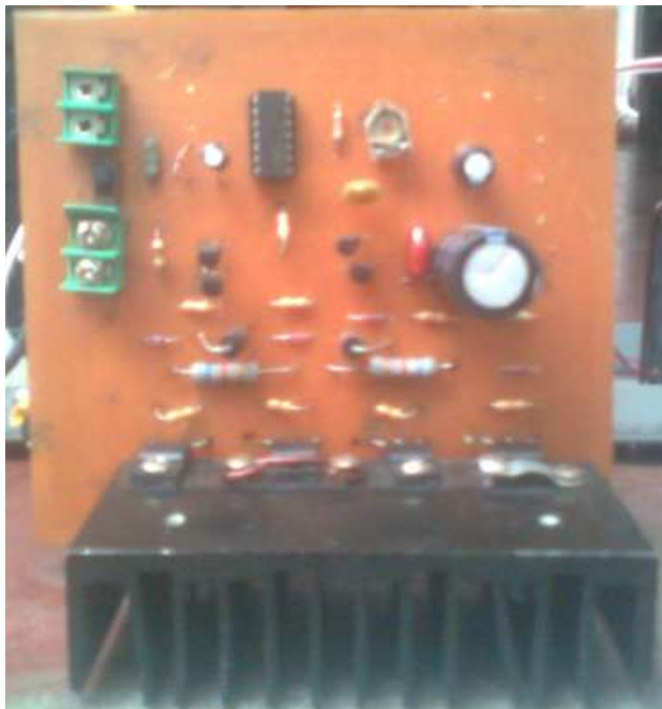
Hình 3.3. Mạch biến đổi DC/AC từ 6VDC lên 220VAC /50Hz.
