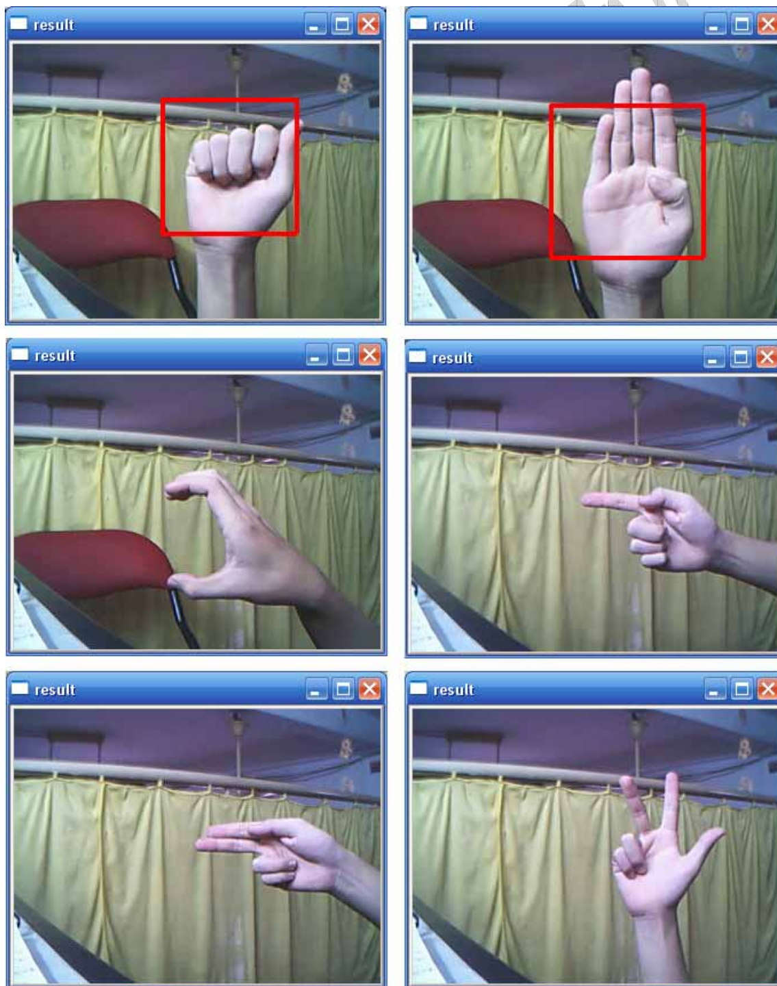
Hình 40 - Vài kết quả test của bộ nhận dạng cử chỉ A (cử chỉ B là một trường hợp false alarm)
