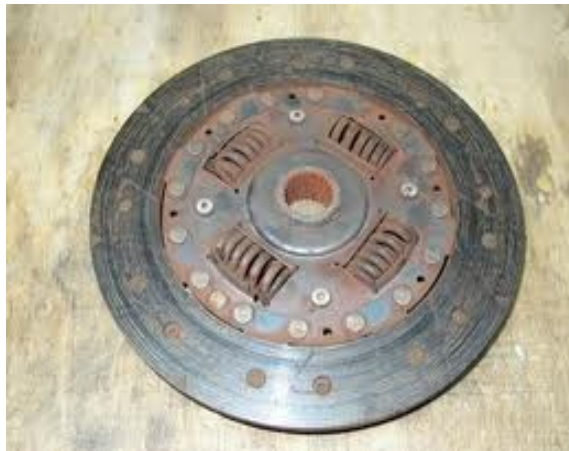
Hình 2.1: đĩa ma sát bị mòn
