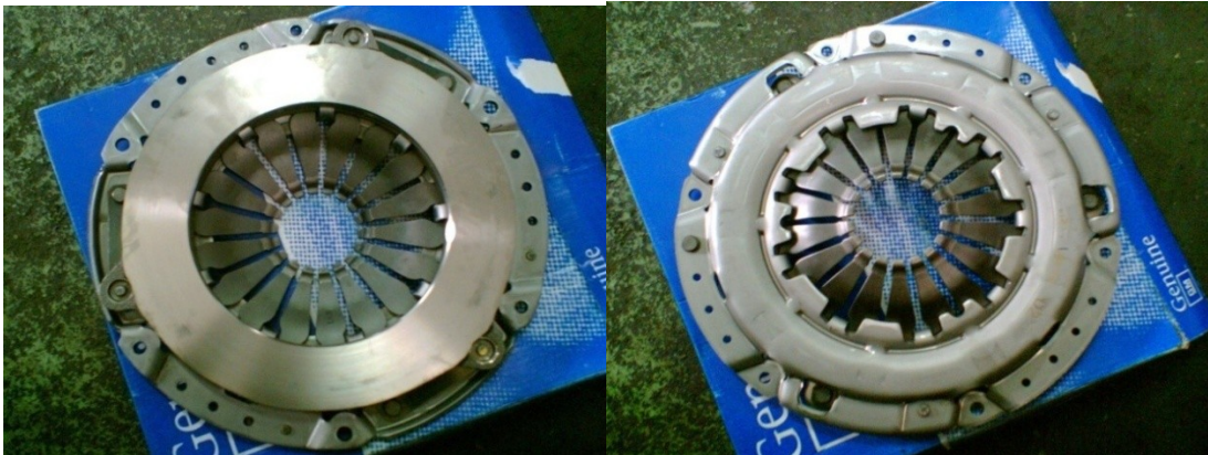
Hình 1.9 : Đĩa chủ động vỏ và lò xo ép
