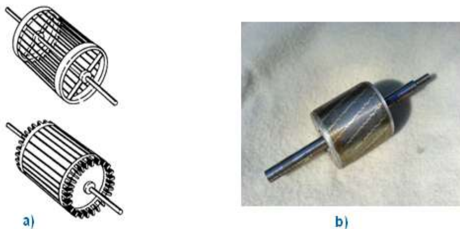
Hình 1.6 Dây quấn rôto lồng sóc (a) và rôto lồng sóc rãnh chéo (b)
