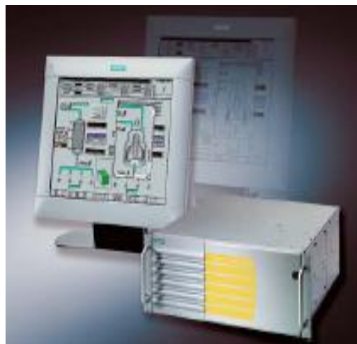
Hình 1.3: Trạm vận hành trong PCS7
