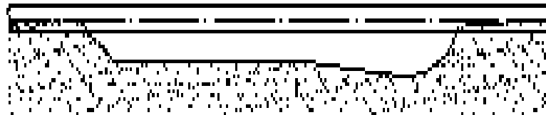
Hình 1.2-Nhịp hẫng do xói đáy ống
