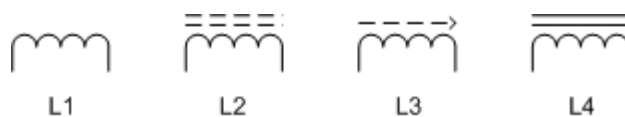
Hình 3.12: Ký hiệu cuộn dây trên sơ đồ : L1 là cuộn dây lõi không khí, L2 là cuộn dây lõi ferit, L3 là cuộn dây có lõi thép, L4 là cuộn dây lõi thép kỹ thuật
