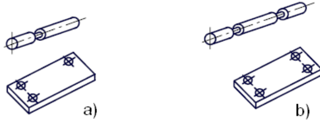
Hình 3-18. ảnh hưởng của kết cấu chi tiết đến khả năng định hướng a) Kết cấu không hợp lý; b) Kết cấu hợp lý
