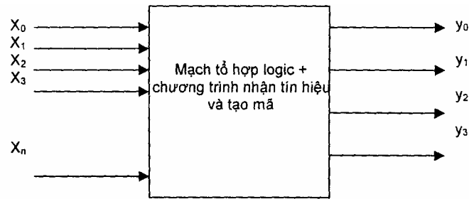
Hình II. 23 Sơ đồ khối một mạch Multiplexer (coder)
