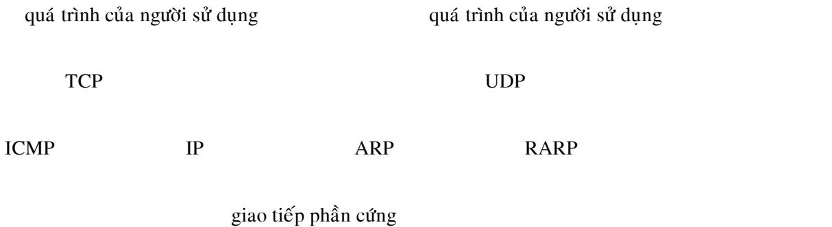
**TCP** (Transmission Control Protocol) Giao thứ hướng đến kết : tin cậy, hai chiều, kiểm soát sự truyền nhận các dòng dữ liệu. Đa số các ứng dụng sử dụng TCP.
