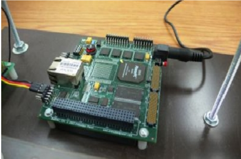
Ảnh 4. Mainboard pc-104, kích thước 90.17mm × 95.89mm
