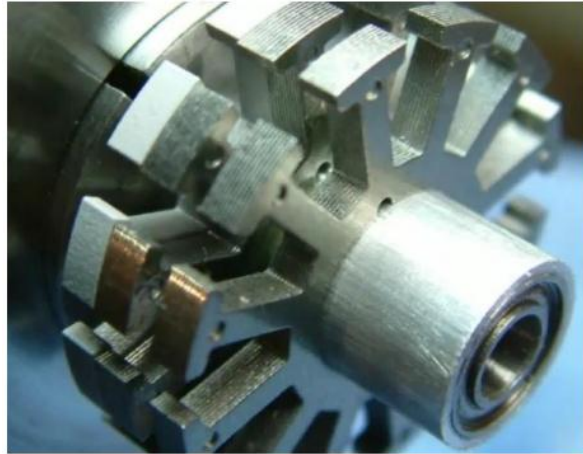
Hình 4.2 – Các lá thép của stator được ghép cách điện với nhau
