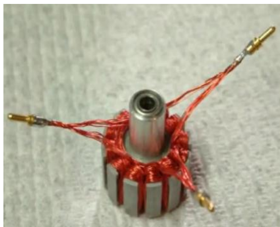
Hình 4.3 – Cách quấn dây trên stator của động BLDC
