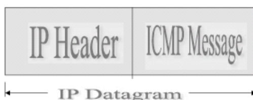
Hình 1.2 Cấu trúc gói dữ liệu IP
