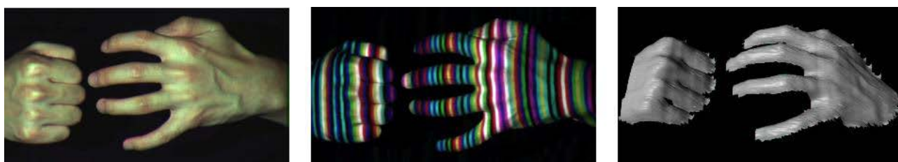
Hình 15: Tái tạo lại bề mặt sử dụng nguyên lý của ánh sáng cấu trúc
