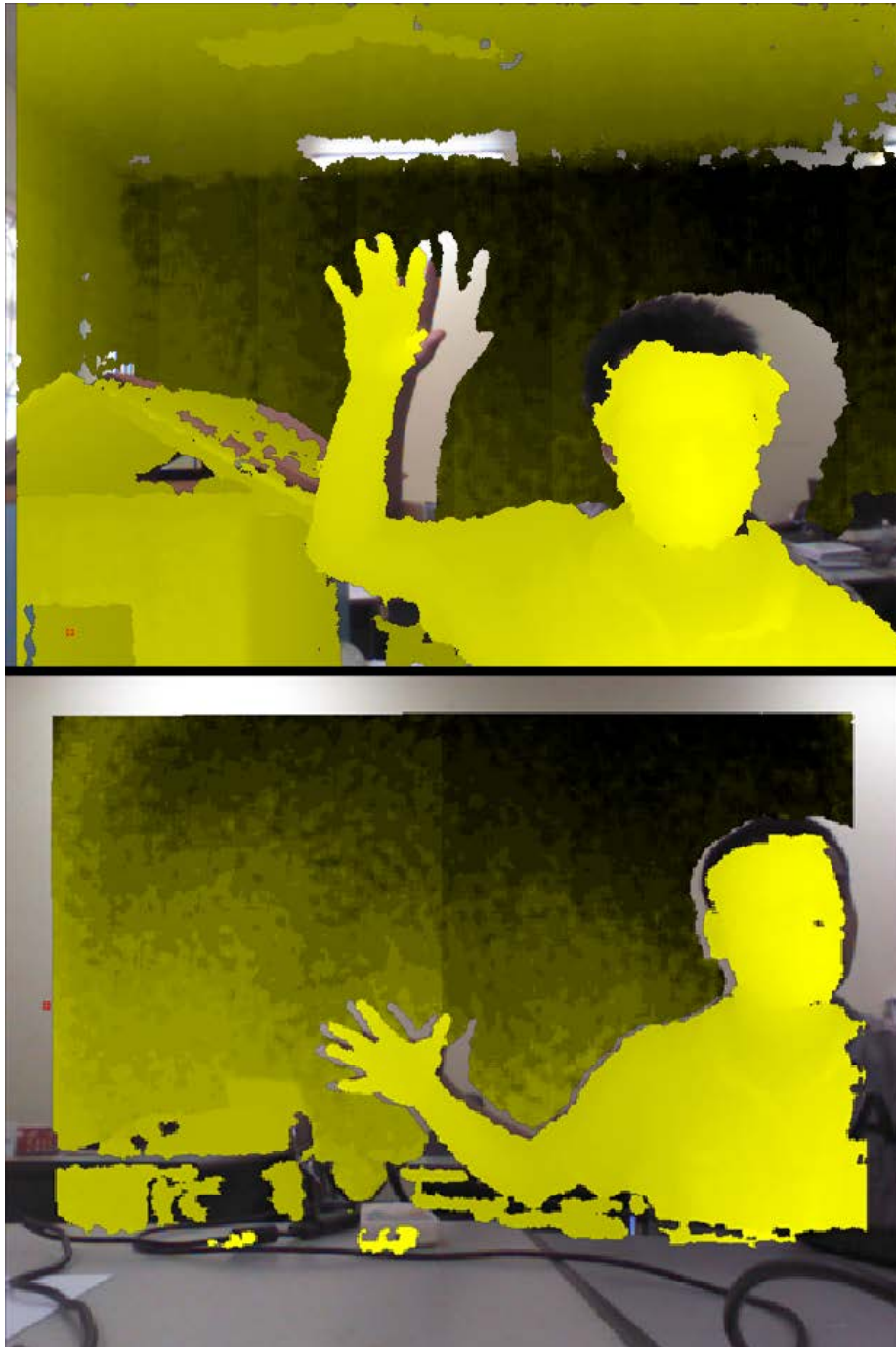
Hình 18: Kết quả trước và sau khi calibration dữ liệu ảnh độ sâu về không gian của ảnh màu
