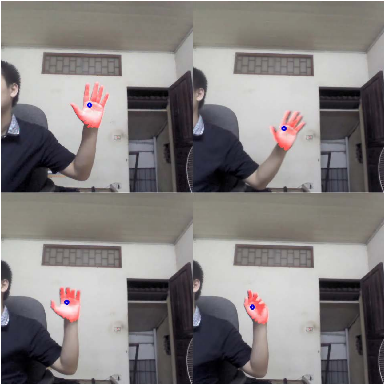
Hình 19: Kết quả nhận dạng mô hình quan sát của bàn tay kết hợp ảnh màu và độ sâu từ cảm biến Kinect
