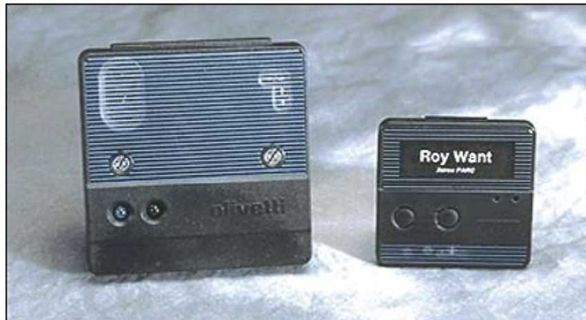
Hình 5-1 Hệ thống định vị Active badge của hãng Olivetti, hình nhỏ bên phải là thẻ Active badge được mang theo bên người sử dụng, bên trái là bộ cảm biến hồng ngoại của hệ thống. Nguồn [6]
