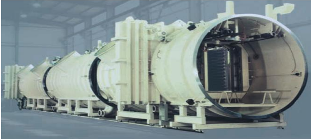
Hình 2.5: Hệ thống sấy thăng hoa trong công nghiệp
