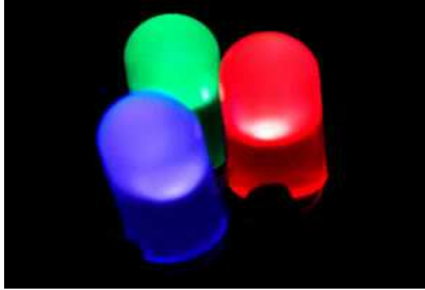
Hình 4.6. Cấu tạo điểm ảnh màn hình LED
