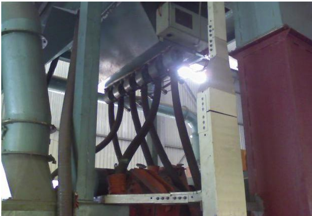
Hình 1.8 Đường cáp bi từ xilo xuống các máy bắn bi
