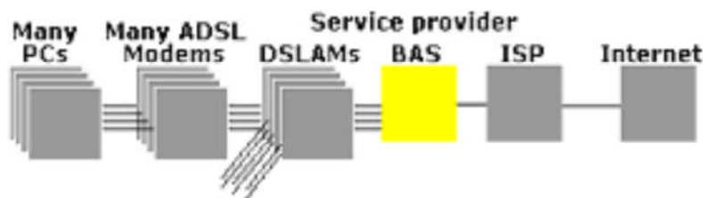
Hình 2.10 Thiết bị BRAS hay BAS
