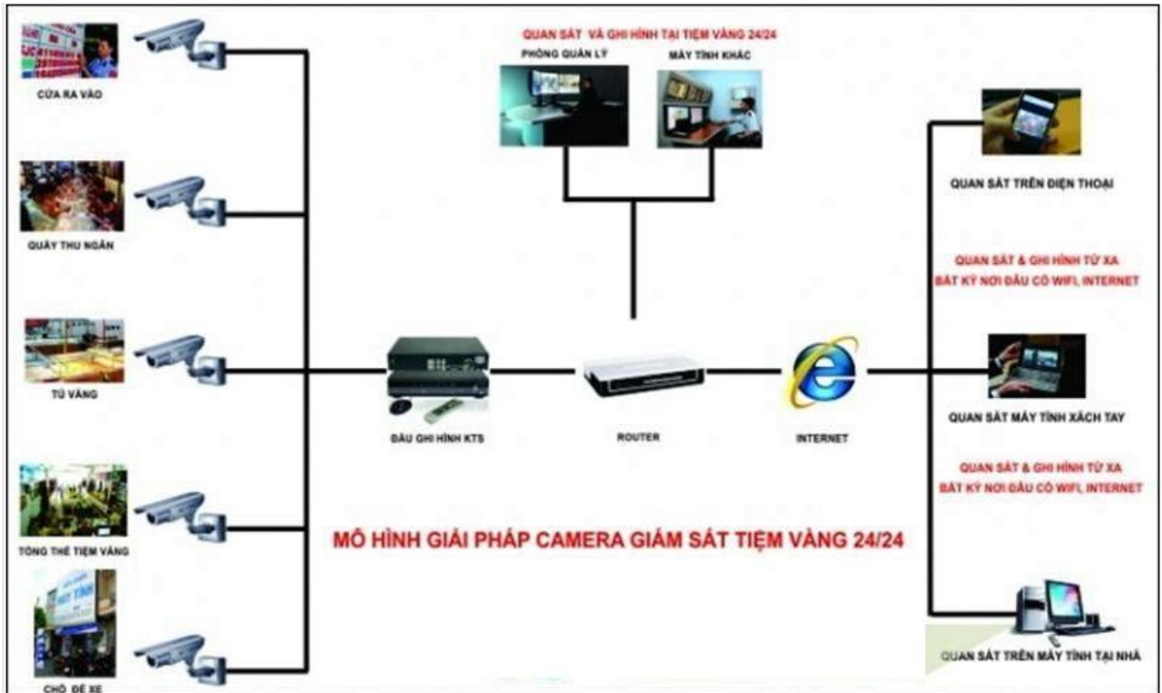
Hình 3.1 Sơ đồ hệ thống camera giám sát ở tiệm vàng
