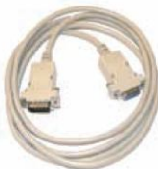
Hình 47 Cáp C232NG1 kết nối cổng RS232 của Energytest 2020E và máy tính
