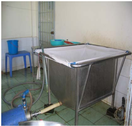
Hình 24: Bồn lọc sữa - Bình chứa sữa
