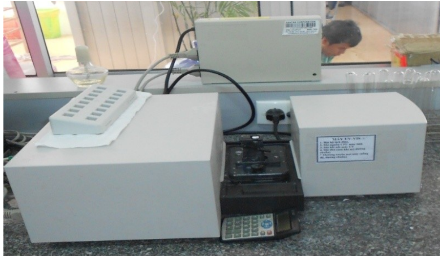
Hình 1. 1 Máy quang phổ tử ngoại khả kiến Agilent 8453UV – visible (Mỹ)
