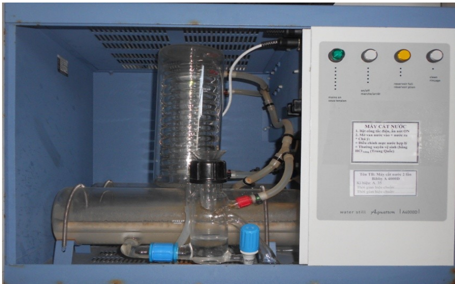
Hình 1.4 Máy cất nước 2 lần
