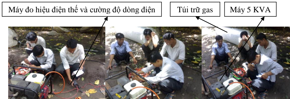
Hình 3.1 : Cách tiến hành các thí nghiệm
